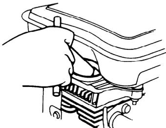
Rys. Wymiana świecy zapłonowej
