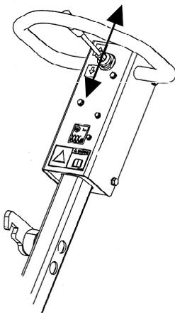
Kierunek jazdy i prędkość ulegają zmianie w zależności od położenia dźwigni układu hydraulicznego.
