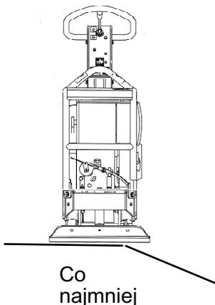
Rys. Umieszczenie urządzenia podczas pracy w pobliżu krawędzi
