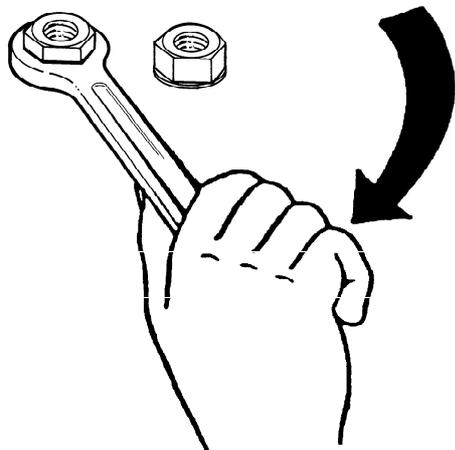
Rys. Sprawdzanie połączeń śrubowych
