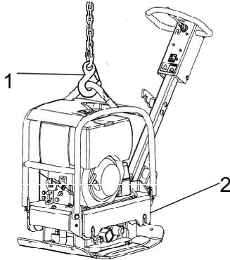
Rys. Urządzenie gotowe do podnoszenia
