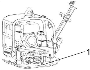
1. Korek spustowy i napełniania oleju
