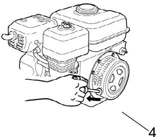
4. Złap uchwyt linki rozrusznika i obróć wałem silnika aż do wycucia oporu. Ustaw uchwyt w położeniu początkowym i pociągnij go gwałtownie, aż do uruchomienia silnika. Stopniowo otwieraj przepustnicę, aż do pełnego otwarcia.
