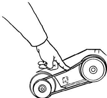
Rys. Sprawdzenie paska klinowego
