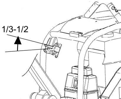
3. Pociągnij przewód rozruchowy do chwili wycucia niewielkiego oporu. Pozwól na całkowity powrót przewodowi do położenia pierwotnego; w ten sposób do uruchomienia silnika można wykorzystać całą długość przewodu rozruchowego.
