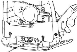
1. Korek spustowy i napełniania oleju
